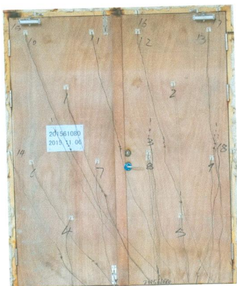
照片 2 耐火试验结束时试件情况
